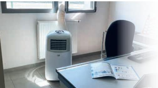
La climatisation fonctionne sur le principe d'un abaissement de la température grâce à un système thermodynamique. Ce procédé permet de retirer de la chaleur d'un côté pour l'évacuer à un autre endroit. Par conséquent, les climatiseurs mobiles nécessitent de sortir une gaine vers l'extérieur, en entrebâillant une fenêtre ou en faisant un trou en façade, afin d'évacuer cette chaleur.
