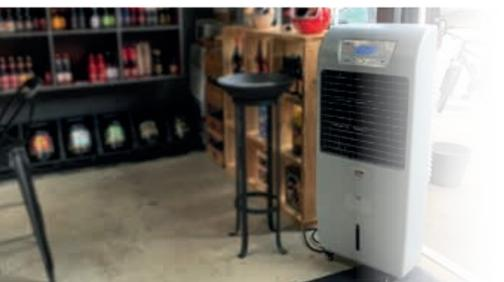
Le rafraîchissement consiste à faire couler de l'eau sur des panneaux de cellulose afin qu'elle soit évaporée sous l'action de l'air chaud et sec traversant l'appareil.
